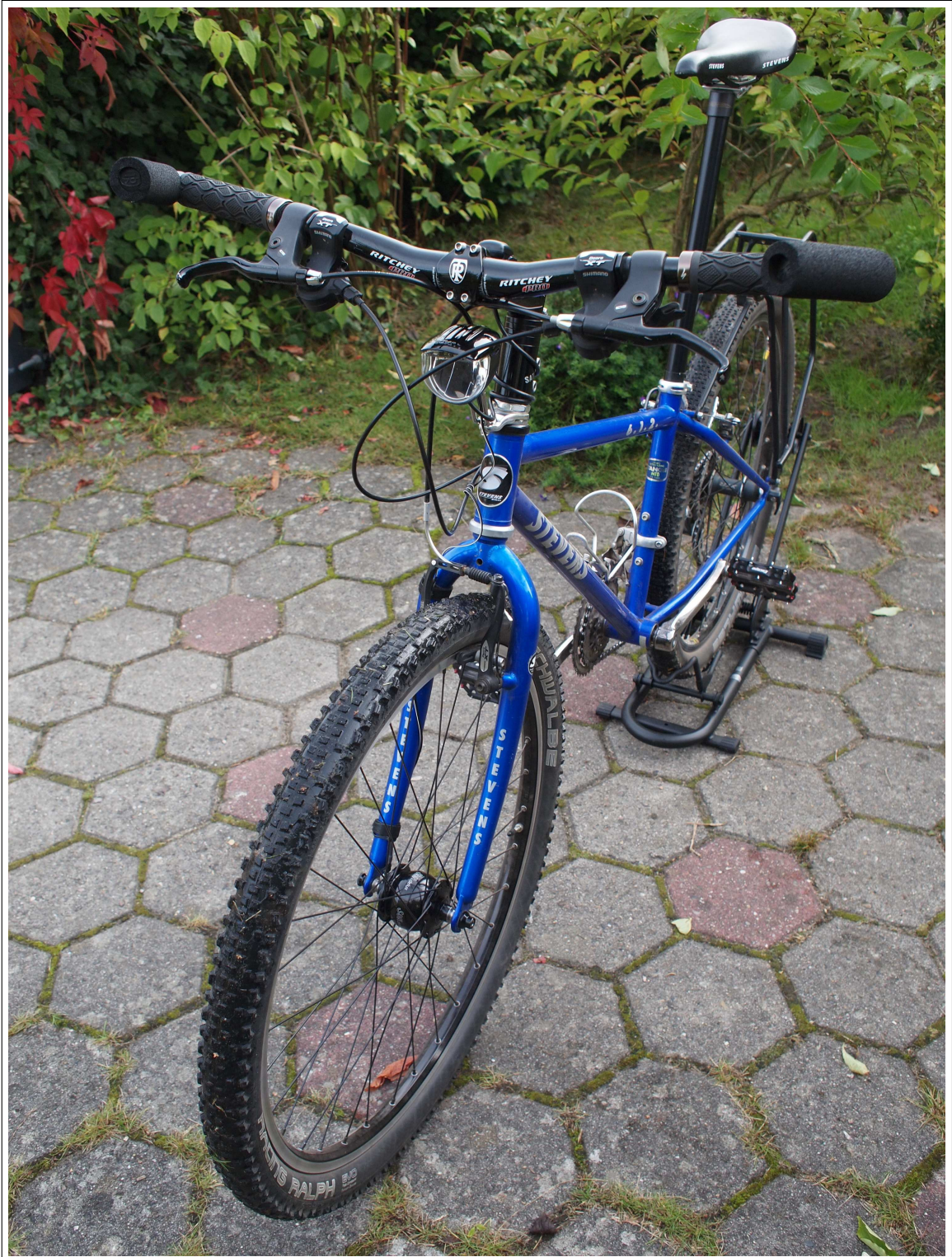
Foto: Bonin, 29-Sep-2014. SONdelux Nabendynamo mit Busch & Müller LED-Scheinwerfer Lumotec IQ2
