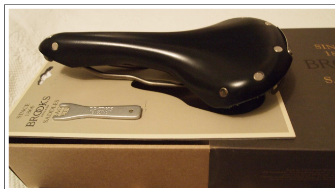
Foto: Bonin, 2014. Schwarzer Kernledersattel mit relativ kleinen Stahlmieten und einem Gestell aus Titanium: Brooks B15 Swallow Titanium Unique \approx 344\text{g} ; Identnummer 1L3.
