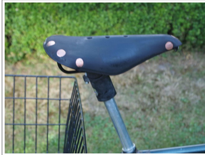
Foto: Bonin, 2010. Ledersattel mit großen Kupfernieten und Gestell aus Stahl: Brooks Professional select \approx 558\text{g} .
