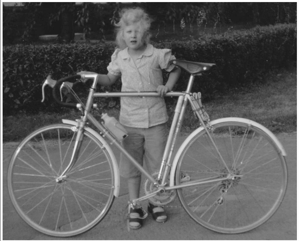
Foto : Bonin, 1984. Hinweis: Relativ große Sattelüberhöhung, Schalthebel an den Enden des Rennradlenkers, Ersatz Reifendecke an den Sitzstreben unterhalb des Sattels, extra Flaschenhalter mit Flasche, Pedalen mit Riemen, Rahmenluftpumpe.
